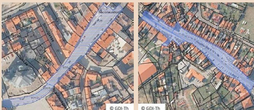
Begonnen wurde die Baumaßnahme mit der Hauptzufahrt „Spittel“ im Jahr 2000. Über die folgenden Jahre wurde die Hauptstraße in mehreren Bauabschnitten realisiert. Es wurden neue Ver- und Entsorgungsleitungen verlegt, die Straßenoberfläche erneuert und die Gehwege sowie Freiflächen neugestaltet.
