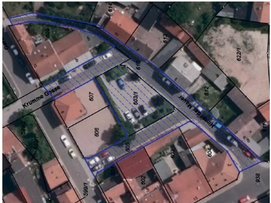
Im Frühjahr 2007 wurde mit der Sanierung der Straßen und Wege begonnen. Die Gehwege erhielten ein Mosaikpflaster aus Kalkstein mit Anschluss an eine 3-zeilige Granit Großpflasterrinne. Für die Fahrbahn kam Basalt-Kleinpflaster zum Einsatz. Durch die niveaugleiche Ausführung der unterschiedlichen Beläge wurde eine ansprechende Mischverkehrsfläche geschaffen. Weiterhin wurden PKW-Stellplätze durch Markierungen im Belag ausgewiesen.
